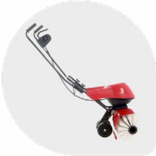
Réf : BALAYEUSE.ELEC Brosse rotative electrique SANDY 60cm Machine de brossage pour gazon synthétique afin de redresser la fibre ou procéder au rechargement en silice (sable) Utilisation régulière pour redressement de la fibre monofilament ou texturisée Fonctionne sur secteur 220V. Revêtement : Padel / Tennis / Multisports.
